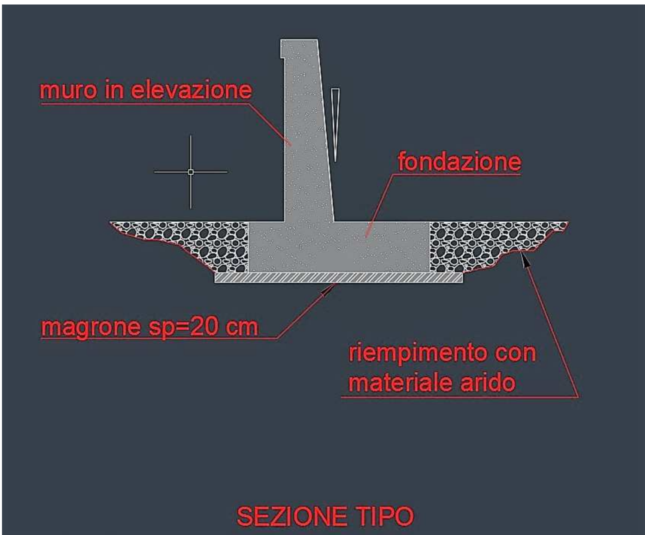
Fig. 11 – Sezione tipo muro di sbarramento in c.a.
